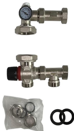
Смесительный узел Wester серии S (DN25, Kvs2.5, PN10, HP 1", 20-43°C)
