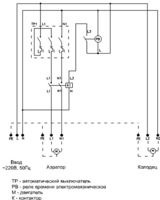
Рис. 5. Принципиальная схема щита управления ЛОС 5М
