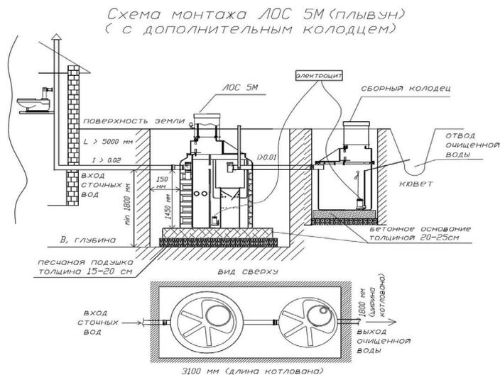
рис. 4.2. Монтажная схема ЛОС 5М со сборным колодцем (плыун)
