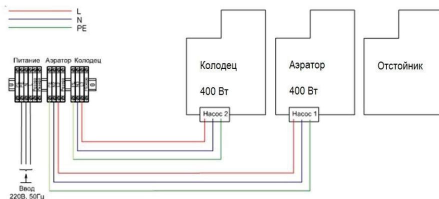
Рис. 6. Схема соединений установки ЛОС 5М.
