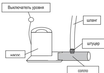
чиком уровня жидкости. Кабель, выходящий из насоса прикрепить к шнуру, далее кабель крепить хомутами. Вывести к отверстию, продеть в герметичный сальник и вывести концы блок управления. Все крепления кабеля выполнять пластиковыми монтажными хомутами 10-12 шт.
