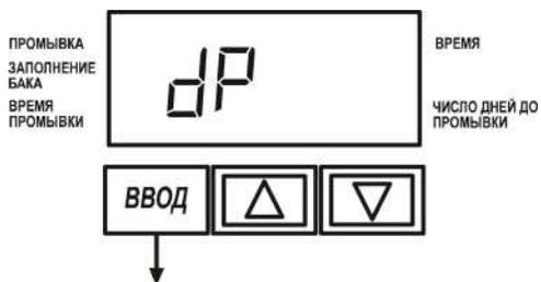
**Шаг 4СН** – Если установлен датчик перепада давления, и он активирован, то далее выбирается способ начала регенерации:
