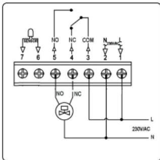
Схема подключения к котлу:
